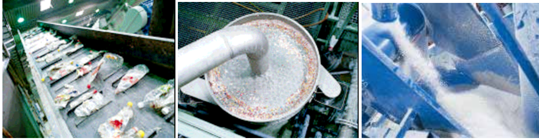
Aufgabe zur Zerkleinerungen der von den Störstoffen befreiten PET-Flaschen, „Schwimm-Sink-Trennung“ der verschiedenen Kunststoffarten und Trocknung der PET-Flakes
