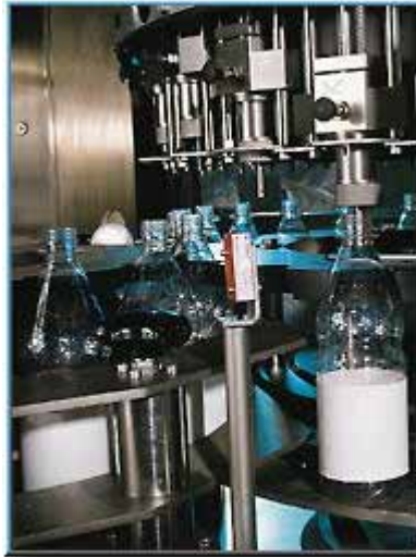
Prüfung auf Sauberkeit, Form und Dichte
